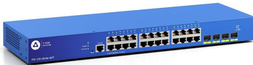
Настраиваемый коммутатор ТГК-125-24/4д-М/Т, оснащенный 24 портами 10/100/1000Base-T и 4 портами 10GBase-X SFP+, поддерживает расширенные функции управления и безопасности, обеспечивая высокую производительность и масштабирование сети. Функции управления включают SNMP, управление на основе Web-интерфейса и интерфейс командной строки (CLI).
